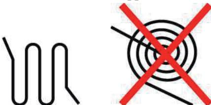
**Figur 2-1** Rekommenderad hantering av överskjutande kabellängd.
