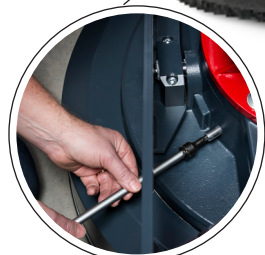
Service 2.0. Lossa tre enkla skruvar för åt- komst till maskinhuset.
