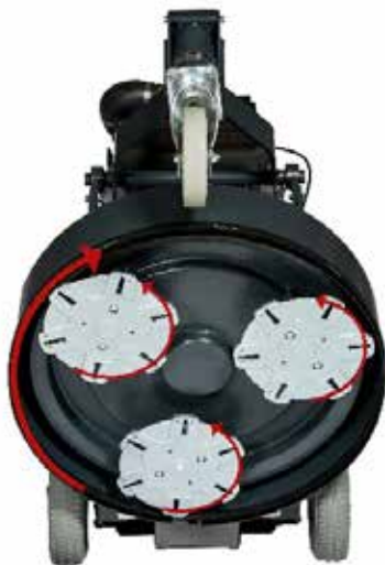
Abbildung 41 – Rotation der Schleifköpfe im Vergleich zum unteren Getriebegehäuse
