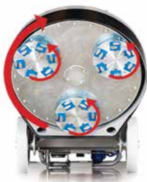
Figur 4.1 Illustrerar hur slipskivorna rör sig i förhållande till sliphuvudet.
