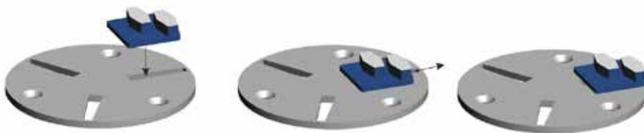
Figur 4.3 Montering av verktyg på Scan-On-fästskivor.
